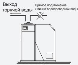
Не используйте предохранительный клапан на трубопроводе добавочной воды и на сливной линии.
