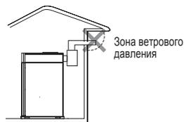
Если жаровая труба устанавливается в зоне с ветровым давлением, это может привести к чрезмерному образованию сажи в результате неполного сгорания топлива, что снижает эффективность агрегата; может быть запущено аварийное отключение, что вызовет нестандартную работу котла. С целью предотвращения этой проблемы жаровая труба должна устанавливаться в месте за пределами зоны ветрового давления.
