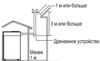
Если на расстоянии 1 м от жаровой трубы есть здание или какое-либо препятствие, труба устанавливается на 1 м выше крыши здания.
