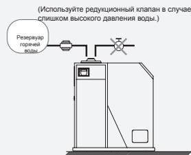
Используйте тройник на нагреваемом выходе трубы отопления и сливной трубы, чтобы установить расширительную трубу на отдельной трубе. (Установите трубу предотвращения естественной циркуляции при установке в подвале.)
