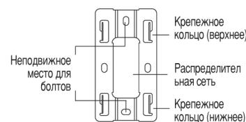
2) Соедините распределительную сеть с клеммами нижней части регулятора температуры в помещении (CTR-5000)
