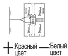
3) Навесить регулятор температуры в помещении на крепежные кольца неподвижной платы, придавить к стене, движением снизу вверх зафиксировать положение регулятора
