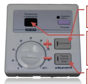
1. Для установки температуры отопления необходимо удерживать кнопку «Отопление» в течении 5-ти секунд.
